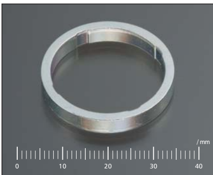
材質 SPCC 従来工法 切削+ブローチ 板厚 T=2.9 新工法 順送 特徴 板厚T2.9→T4.5 薄肉リング成形
