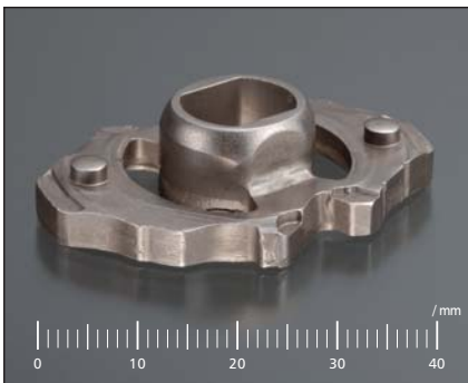
材質 SPH490 従来工法 焼結 板厚 T=3.95 新工法 順送 特徴 絞り高さ10、カム機能部輪郭度0.05以下
