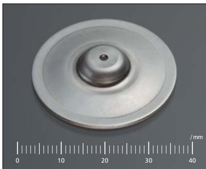
材質 SUS304 従来工法 — 板厚 T=1.0 新工法 順送 特徴 センター穴と外径同軸度0.07
