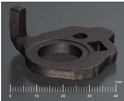
材質 S45C 従来工法 FB+単発 板厚 T=4.5 新工法 順送 特徴 難加工材のシェーピング加工
