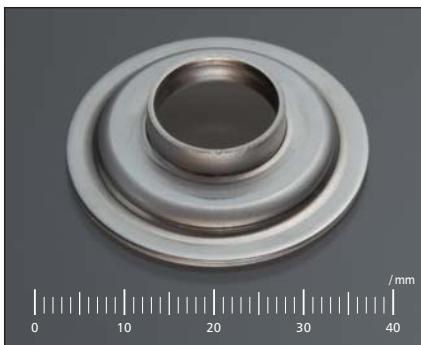
材質 SUS304 従来工法 — 板厚 T=1.2 新工法 順送、ネジ切り 特徴 シール面の平面度0.03
