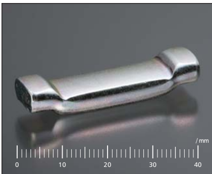
材質 SWCH20K 従来工法 鍛造 板厚 φ8 新工法 ヘッダー+プレス冷間鍛造 特徴 円柱ブランクからのスクラッププレス成形
