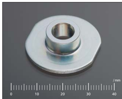
材質 SAPH440 従来工法 トランスファー加工+切削 板厚 T=2.0 新工法 順送 特徴 絞り高さ9.35、増肉2.0→2.5
