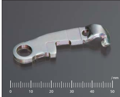
材質 SAPH440 従来工法 — 板厚 T=2.9 新工法 順送 特徴 せん断面80%
