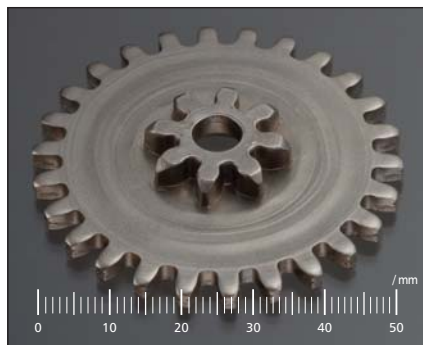
材質 SPCE 従来工法 焼結 板厚 T=3.2 新工法 順送 特徴 増肉
