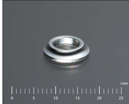
材質 SPCC 従来工法 切削 板厚 T=1.6 新工法 順送 特徴 精密R成形
