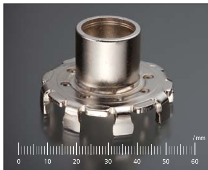
材質 SCM415 従来工法 トランスファー加工+切削 板厚 T=2.3 新工法 順送+単発(ピラス) 特徴 円筒外径φ21.6 0/-0.05
