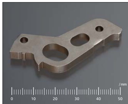
材質 SPH440 従来工法 FB 板厚 T=5.5 新工法 順送 特徴 せん断面100%・ダレゼロ
