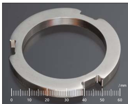
材質 SPH490 従来工法 FB+切削 板厚 T=6.0 新工法 精密せん断工法 特徴 せん断面100%・ダレ0.5MAX。内径切削品をプレス化提案
