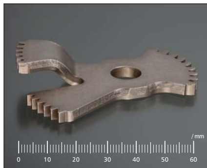
材質 SPH440 従来工法 FB+単発(曲げ) 板厚 T=4.5 新工法 順送 特徴 段違いギア部のシェービング加工
