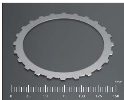
材質 SK85 従来工法 FB 板厚 T=1.32 新工法 精密せん断工法(1ショット加工) 特徴 SK材の精密打ち抜き
